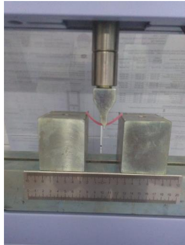
Gambar 6: Uji Kekuatan Transversal plat nilon thermoplastik lucitone-FRS
