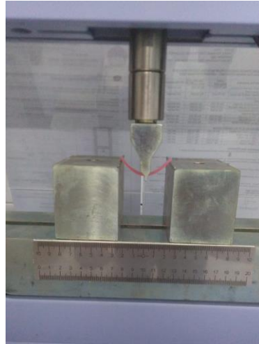
Gambar 6: Uji Kekuatan Transversa plat nilon thermoplastik lucitone-FRS
